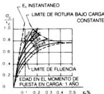
RELACION ENTRE LA TENSION DEL HORMIGON Y LA TENSION DE ROTURA POR COMPRESION EN PROBETAS CILINDRICAS
