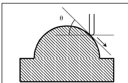
Fig. 22.1.2 (d) During descent on the Z-axis
