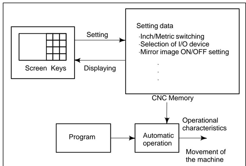
Fig. 1.6 (d) Displaying and Setting Operator's setting data
