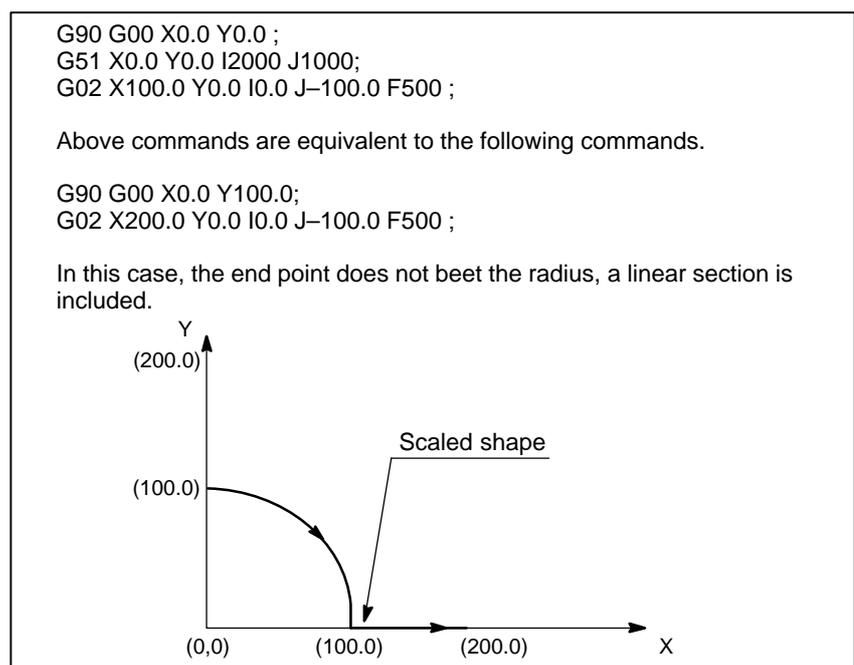
**Fig. 14.9 (d) Scaling for circular interpolation 2**
