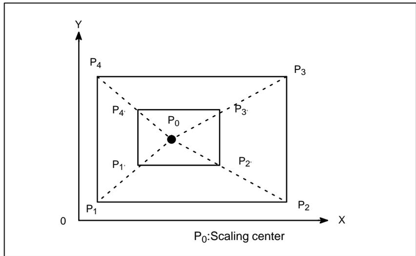
Fig. 14.9 (a) Scaling(P<sub>1</sub> P<sub>2</sub> P<sub>3</sub> P<sub>4</sub>→P<sub>1</sub>'P<sub>2</sub>'P<sub>3</sub>'P<sub>4</sub>)
