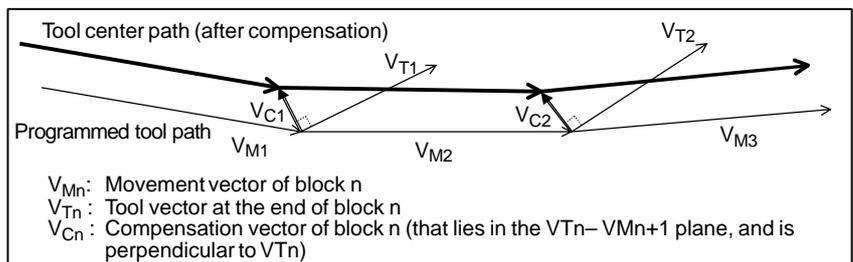
**Fig. 22.5.2 (d) Operation in the compensation mode**
