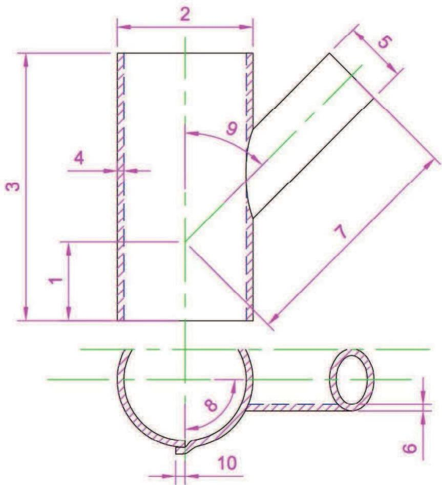
fig. 16 – Innesto di tubo inclinato (in asse)
