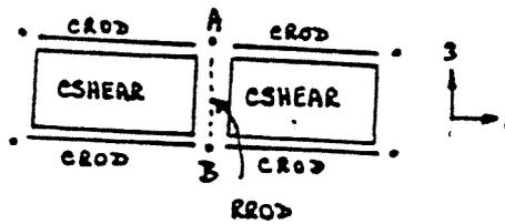
GRID A IS LINKED TO GRID B BY A RIGID RROD ELEMENT
