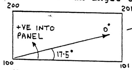
MATERIAL DIRECTION SPECIFIED AS ANGLE FROM 1-2 EDGE OR CORD SYSTEM 1
