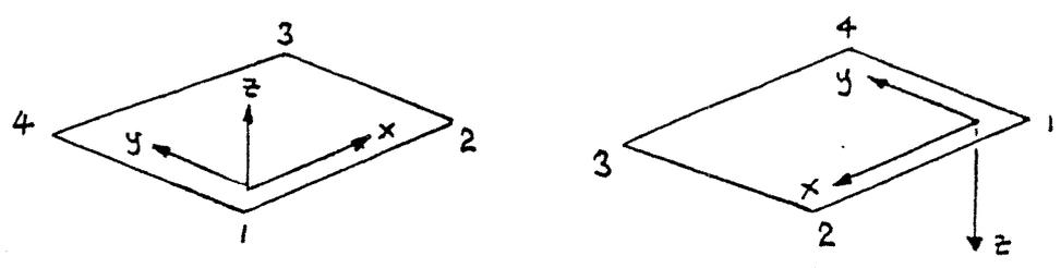
+VE PRESSURE GIVES LOAD IN THE ELEMENT LOCAL Z DIRECTION.
