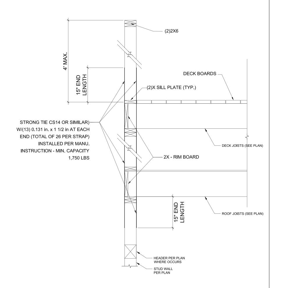
OFFSET STUDS FROM JOISTS TO ALLOW FOR THE STRAPS TO CONTINUE UNINTERUPTED
