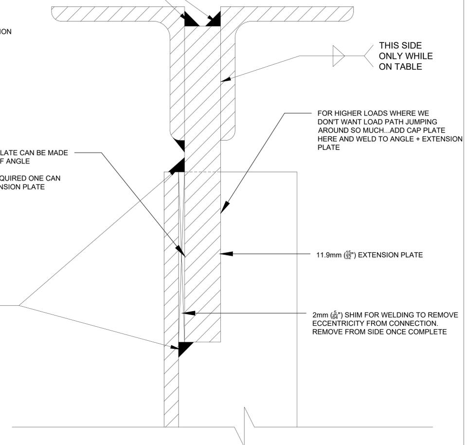
WELD IN A JIG PRIOR TO LAYING TRUSS ON TABLE
