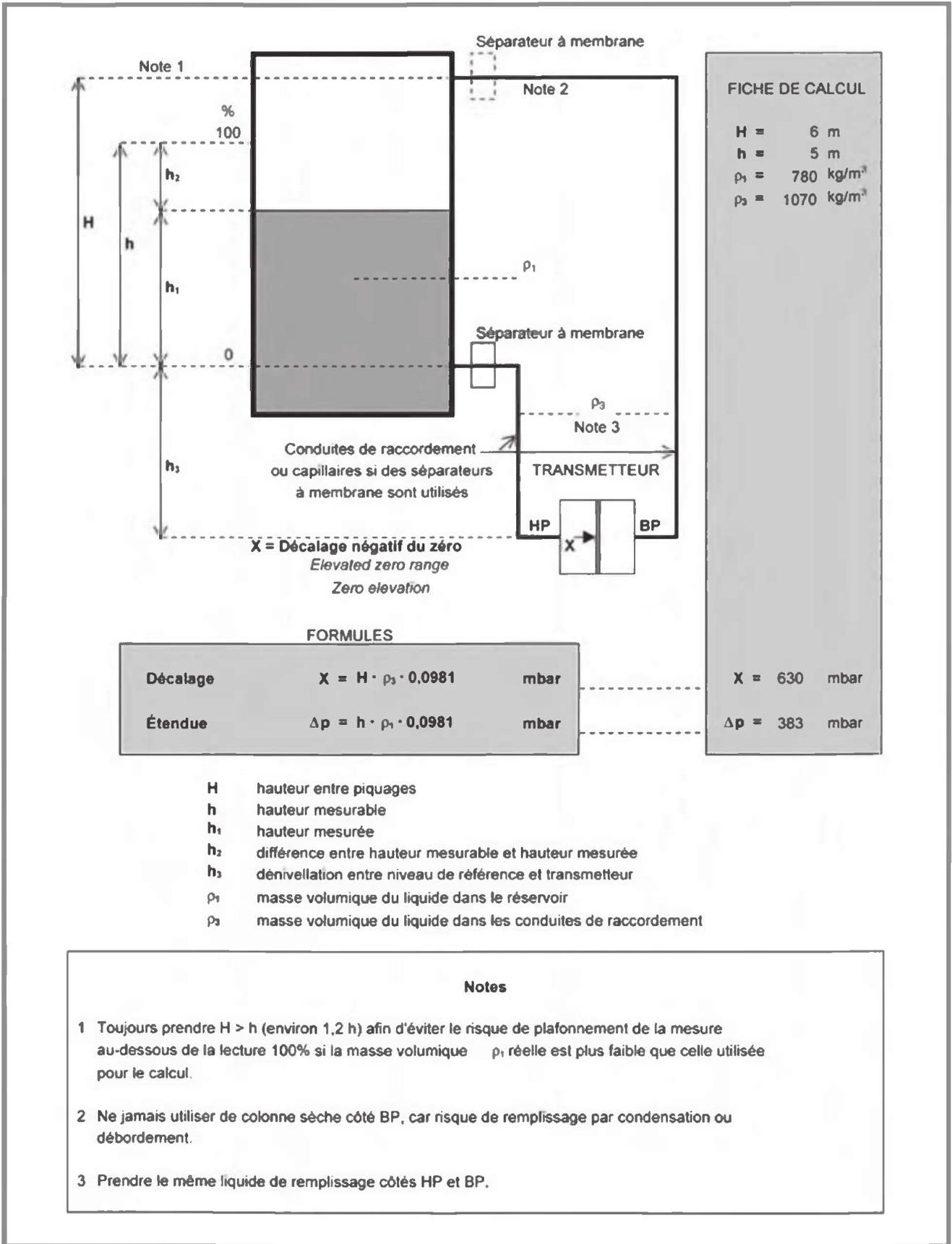
Figure 6.7-A – Niveau hydrostatique d'interface liquide-gaz pour réservoir fermé, avec transmetteur dp sans bride.
