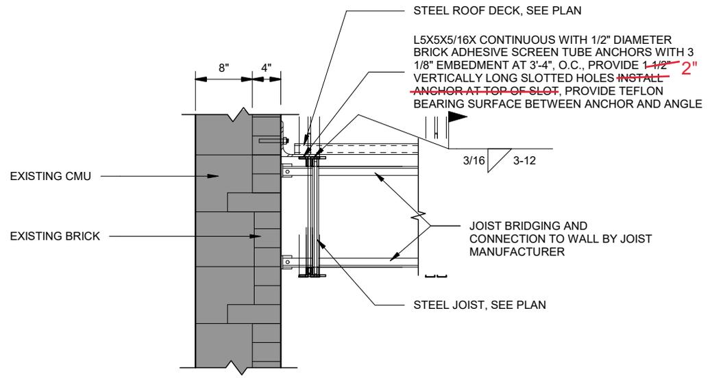
**6** PENTHOUSE JOIST BRIDGING DETAIL
