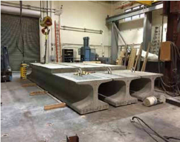
(d) Demolded Concrete Deck
