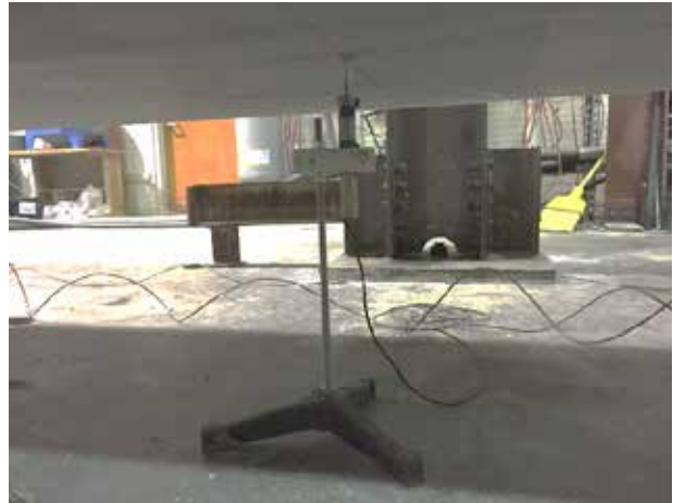
(d) LVDT Below Girder at Midspan
