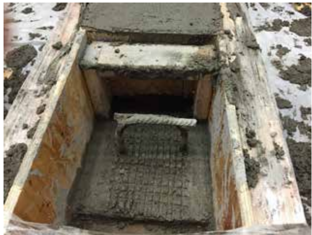
(d) Finished Rough Middle Surface
