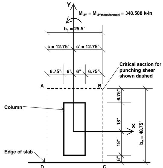
**Figure 12: Edge Column With Edge Parallel To X-Axis
