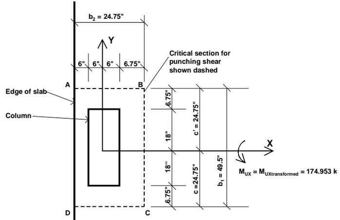
Figure 13: Edge Column With Edge Parallel To Y-Axis
