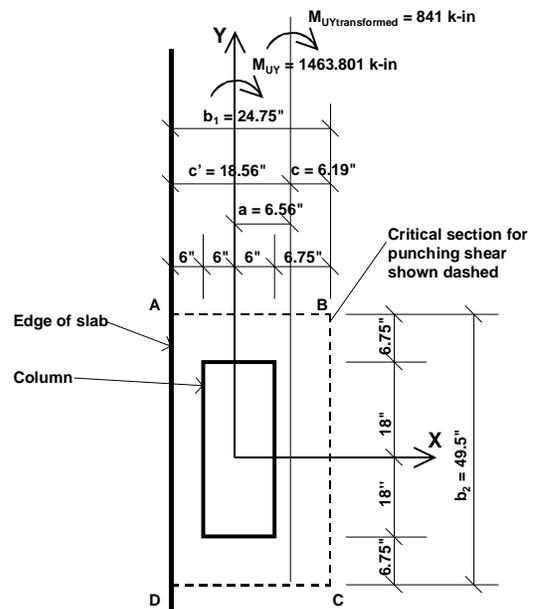
Figure 14: Edge Column With Edge Parallel To Y-Axis
