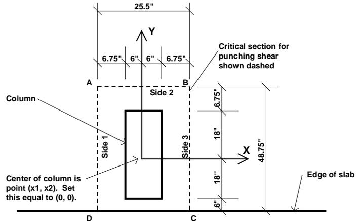
**Figure 6: Edge Column With Edge Parallel To X-Axis. Point 6 in SAFE Model**
