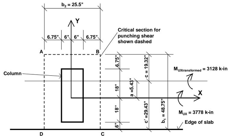
**Figure 11: Edge Column With Edge Parallel To X-Axis
